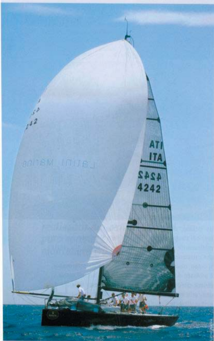
Ancora due immagini del Gp42 impegnato nelle prove sostenute in luglio a Valencia. Con circa 10 nodi di vento ha stretto la bolina fino a 38 gradi rispetto all'apparente, toccando una velocità di 8,4 nodi.
