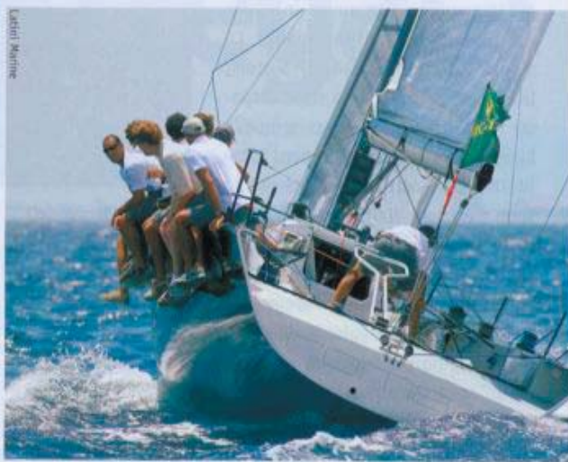
Ancora due immagini del Gp42 impegnato nelle prove sostenute in luglio a Valencia. Con circa 10 nodi di vento ha stretto la bolina fino a 38 gradi rispetto all'apparente, toccando una velocità di 8,4 nodi.
